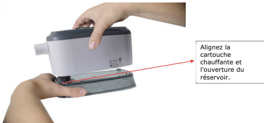
Figure 1: Alignez la cartouche chauffante et l'ouverture du réservoir. Abaissez l'appareil sur le réservoir. Les aimants s'engagent pour maintenir les deux parties ensemble.
